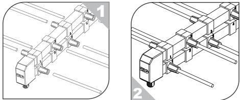
3 - Adicione a garra, parafusos, arruelas, porcas e o vergalhão na antena.
