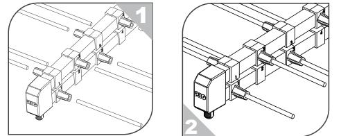
3 - Adicione a garra, parafusos, arruelas, porcas e o vergalhão na antena.
